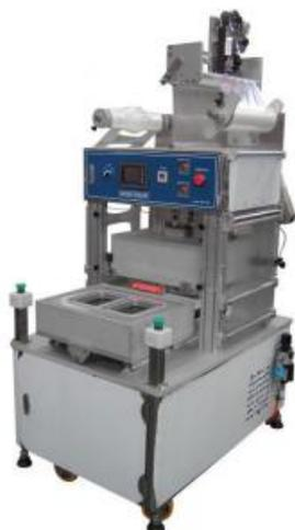
240 (x2) циклов в час, размер контейнера до 150x260x100 (x2) мм
