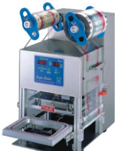
до 480 циклов в час, размер контейнера до 140×140×180 мм
