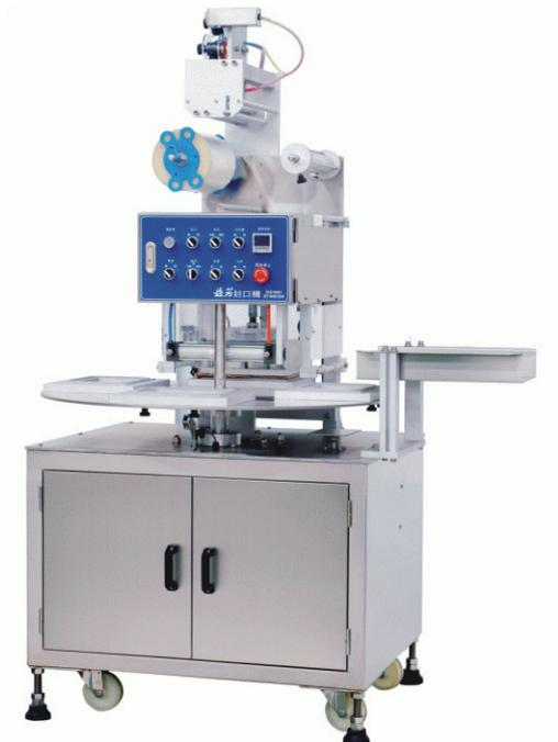
до 960 циклов в час, размер контейнера до 95×75×100 мм
