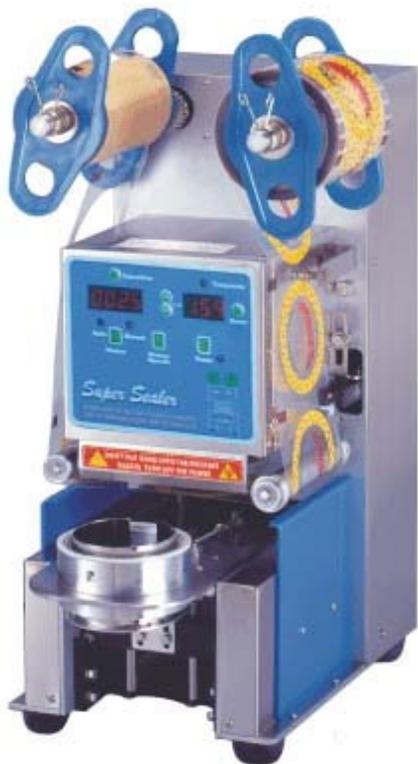
до 480 циклов в час, размер контейнера до 100×100×180 мм
