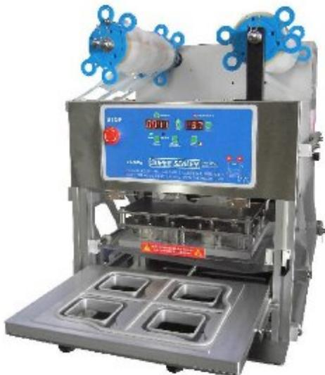
480 циклов в час, размер контейнера до 220×170×100 мм
